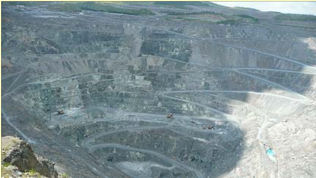
Black Lake, la plus grande mine à ciel ouvert d'amiante au monde.(2.1km x 1.5km x 375m profond)
